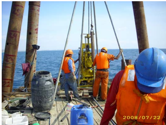
Figura 1. Equipo de percusión y rotación durante el ensayo SPT
