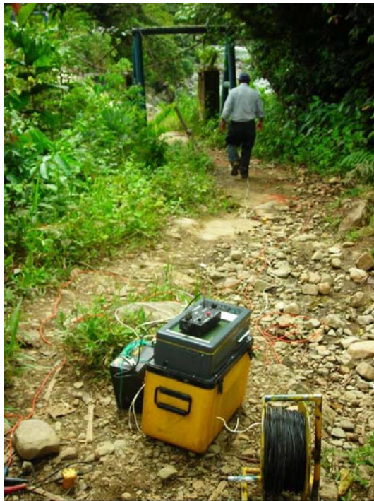
Foto 6.- Realización de la prospección sísmica en campo, Línea Sísmica 2 (LS-2). Margen Derecha
