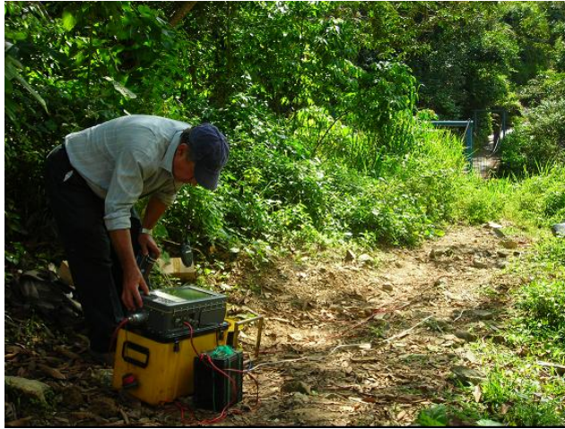
Foto 5.- Realización de la prospección sísmica en campo, Línea Sísmica 1 (LS-1). Margen Izquierda
