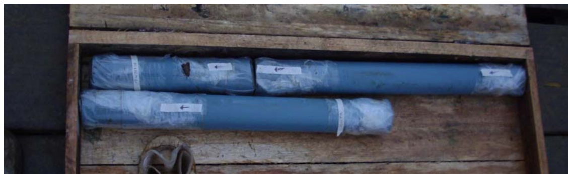
Conservación de muestras inalteradas con muestreador Denisón en la perforación PA-8
