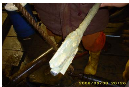
Prueba de corte con veleta de campo en PA-3
