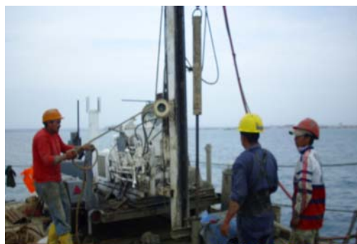
Ensayo de SPT con martillo Safety durante la perforación PA-1
