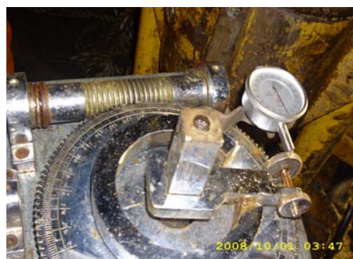
Prueba de corte con veleta de campo en la perforación PA-1, en 24,65 metros de profundidad.
