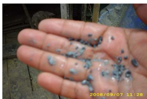
Descripción visual de campo durante el lavado en PA-3 en 25,50 metros de profundidad
