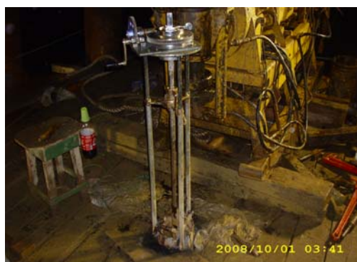
Prueba de corte con veleta de campo en la perforación PA-1, en 24,65 metros de profundidad.
