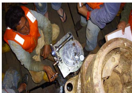
Prueba de corte con veleta de campo en PA-5
