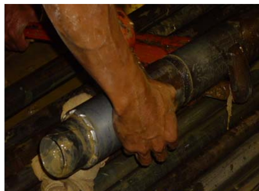
Recuperación de muestra inalterada con Denison en la perforación PA-2, profundidad 34,50 metros hasta 35,10 metros de profundidad.
