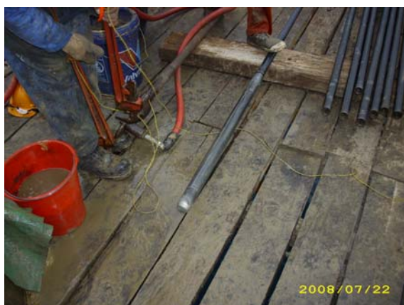
Extracción de muestras alteradas con cuchara partida en perforación PA-8
