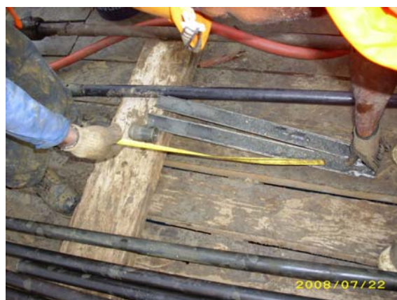
Extracción de muestras alteradas con cuchara partida en perforación PA-8
