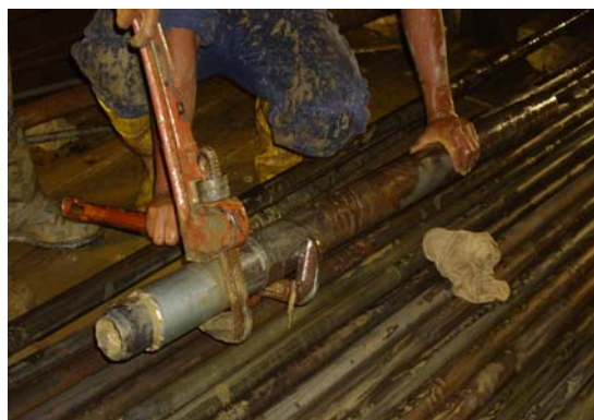
Recuperación de muestra inalterada con Denison en la perforación PA-2, profundidad 34,50 metros hasta 35,10 metros de profundidad.
