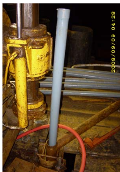
Colocación de tubería de pvc en PA-3 para realizar el ensayo de Down Hole
