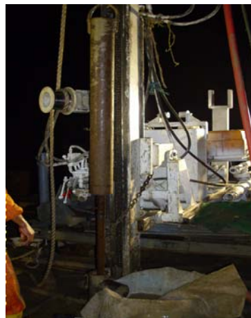
Vista de martillo Safety empleado para realizar SPT en la perforación P-6, durante las jornadas diurnas y nocturnas.
