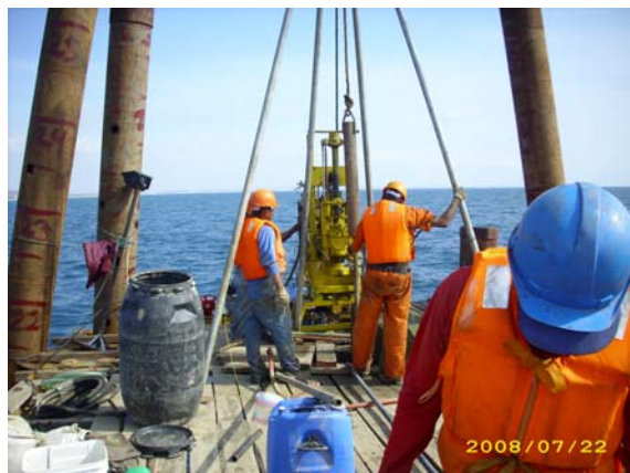
SPT con el martillo Safety durante la perforación en PA-8
