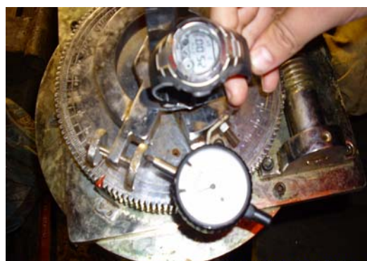
Prueba de corte con veleta de campo en PA-5
