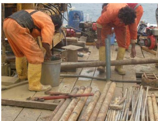
Extracción de muestras con cuchara partida en PA-4
