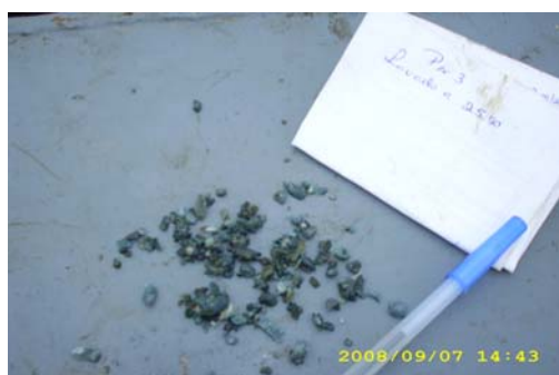
Descripción visual de campo durante el lavado en PA-3 en 25,50 metros de profundidad
