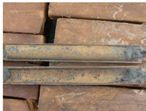
Extracción de muestras con cuchara partida en PA-4
