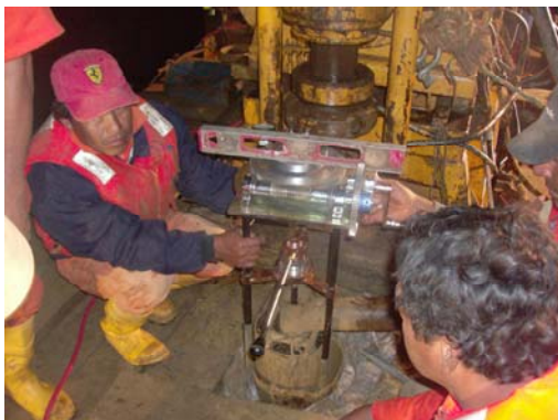
Prueba de corte con veleta de campo "VST" en PA-4
