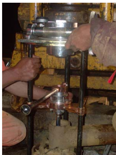
Prueba de corte con veleta de campo y colocación de la tubería de pvc para realizar el ensayo de Down Hole en la perforación PA-10
