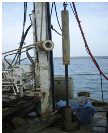
Vista de martillo Safety empleado para realizar SPT en la perforación P-6, durante las jornadas diurnas y nocturnas.
