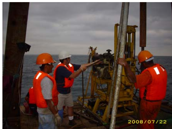
SPT con el martillo Safety durante la perforación en PA-8
