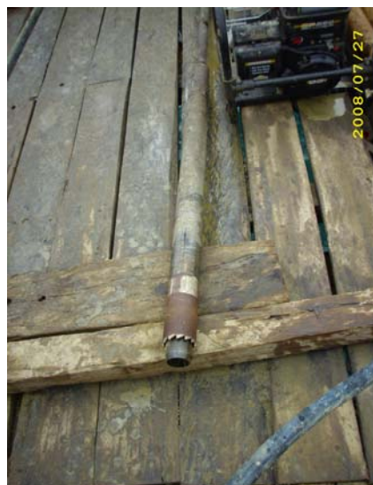
Broca triconica para rotación y lavado. Denisión para muestras inalteradas de arcillas duras utilizadas en la perforación PA-8
