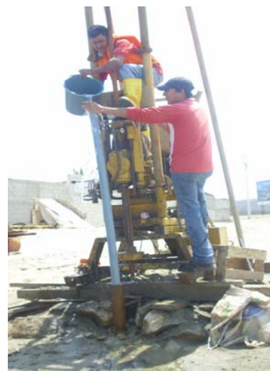
Prueba de corte con veleta de campo y colocación de la tubería de pvc para realizar el ensayo de Down Hole en la perforación PA-10
