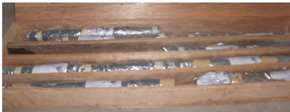
Almacenamiento de muestras con SPT y barril doble pared en la perforación PA-10
