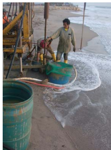
En la perforación PA-10 realizando ensayo de SPT con el martillo Safety
