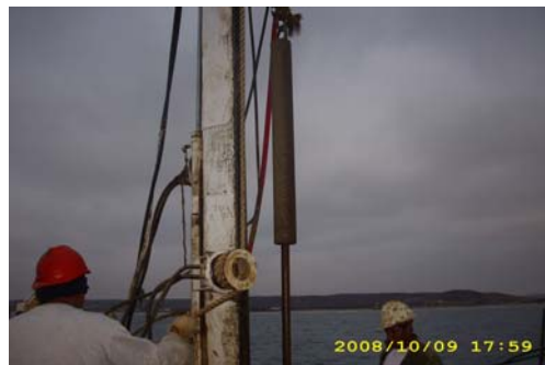
Utilización de martillo Safety durante ejecución del SPT en la perforación PA-5
