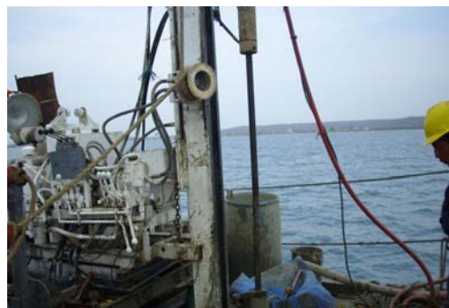
Ensayo de SPT con martillo Safety durante la perforación PA-1
