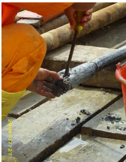
Broca triconica para rotación y lavado. Denisión para muestras inalteradas de arcillas duras utilizadas en la perforación PA-8
