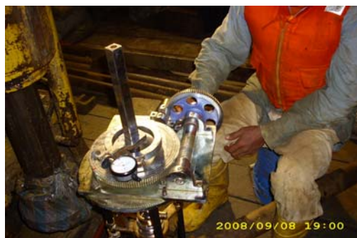
Prueba de corte con veleta de campo en PA-3
