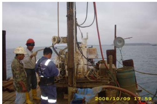
Utilización de martillo Safety durante ejecución del SPT en la perforación PA-5
